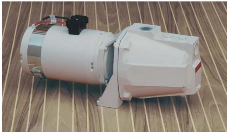
Elettropompa centrifuga autoadescente a getto, idonea per servizio di bordo di acqua dolce o salata. Funzionamento silenzioso. Costruzione con corpo e girante in bronzo, asse in acciaio AISI 316, tenuta rotante in ceramica.
