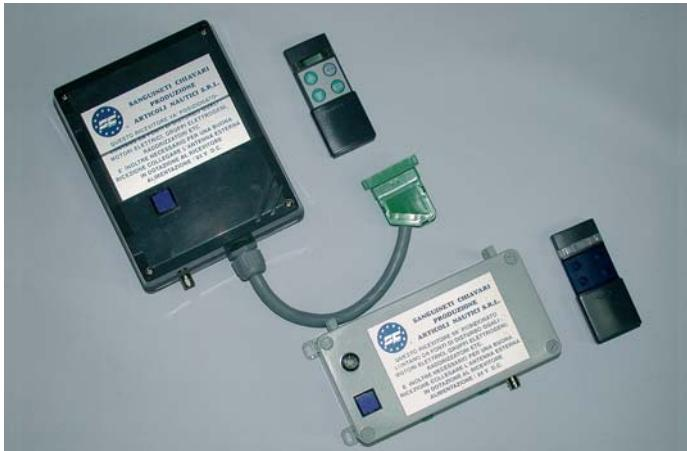
Radiocomandi standard per passerelle ed azionamenti elettrici. Esecuzione con trasmettitori quarzati con codice di sicurezza di accesso. Disponibili a 2-4-6-8 canali. Alimentazione centralina 24V d.c..
