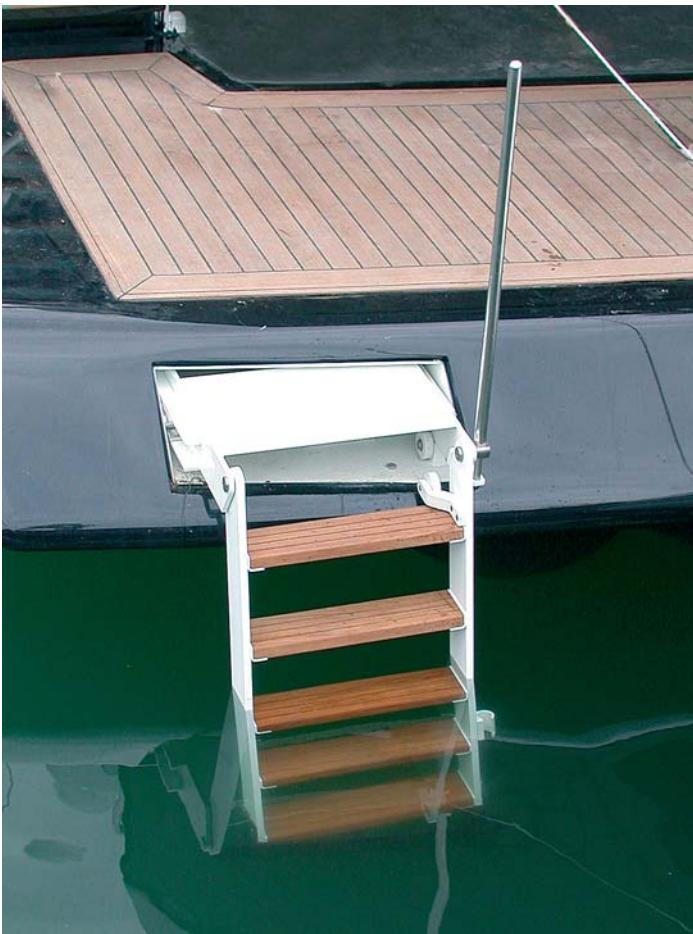
Scaletta da bagno motorizzata: costruzione in lega leggera e acciaio inox verniciata, gradini fissi in teak massello rigato. Comando oleodinamico di scorrimento, discesa guidata per gravità'. Sistema di traslazione, completamente estraibile, fine corsa di segnalazione scaletta estraetta.
