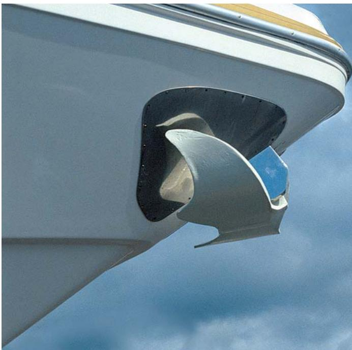
Ancora a baricentro avanzato per installazione in cubia centrale o musone sovraccoperta.
