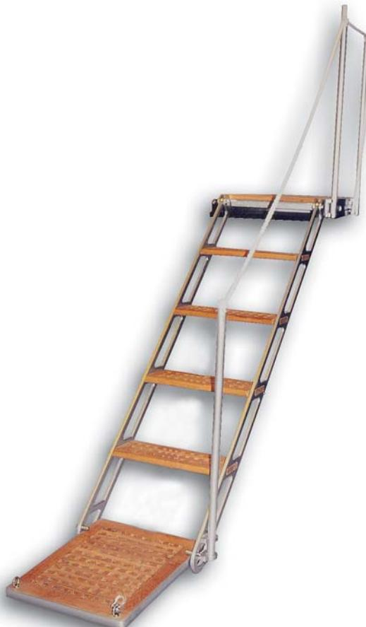
Scala reale tradizionale manuale con gradini fissi, pianerottolo inferiore ripiegabile, costruzione in lega leggera anodizzata, piano di calpestio in teak naturale a carabottino. Fissaggio a scafo con piastra in acciaio inox a scontro senza sostegno inferiore a "Y".
