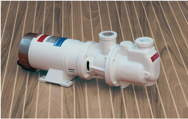
Elettropompa monovite autoadescante per scarico acque nere o fluidi oleosi o fangosi. Corpo pompa in bronzo, rotore e giunto cardanico in acciaio inox, statore in gomma.
