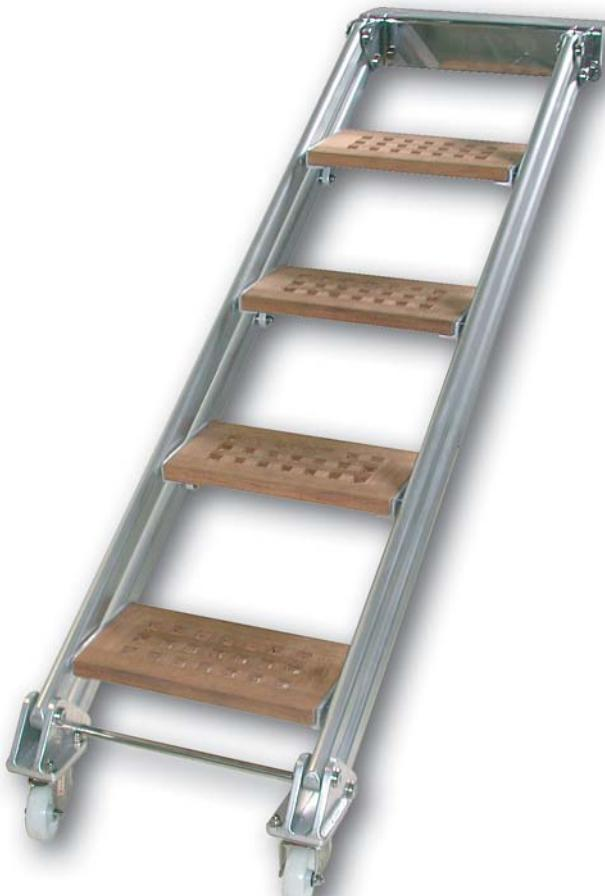
Scaletta laterale manuale: costruzione in lega leggera anodizzata, piastra di attacco in acciaio inox, gradini autolivellanti in teak a carabottino. Ruote pivotanti all'estremità.
