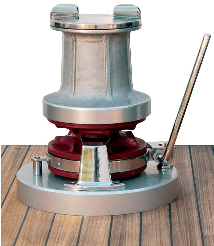
Verricello verticale elettrico 4000-3000. Costruzione con base e campana in lega leggera anodizzata. Trascinamento della ruota ad impronte in bronzo con frizione doppia con comando a leva. Freno a nastro con comando a leva estraibile.
