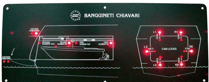
Quadri di comando programmabili con gestione logica degli azionamenti. Completati con pannello sinottico di segnalazione e pulsanti manuali di emergenza.
