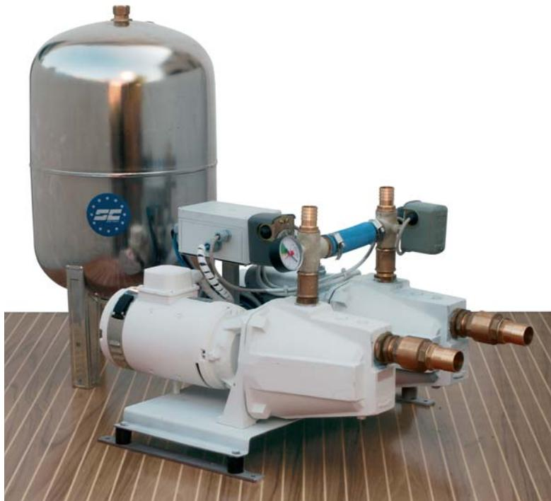
Autoclave con doppia pompa autoadescente. Funzionamento silenzioso per la distribuzione di acqua in pressione. Serbatoio in acciaio inox a membrana. Gruppo motopompe separato; doppio pressostato. Pompe con corpo in bronzo; girante in lega speciale di ottone, asse AISI 316, tenuta rotante in ceramica/grafite.
